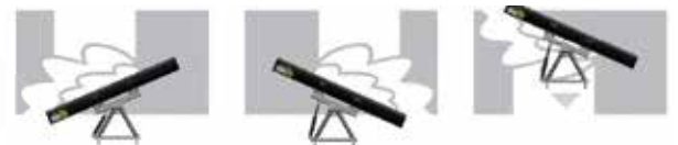
1: Stecknagel einhängen oder entfernen 2: Räder positionieren 3: Stromversorgung anschliessen, abhängen 4: Schneepflug wegrollen
