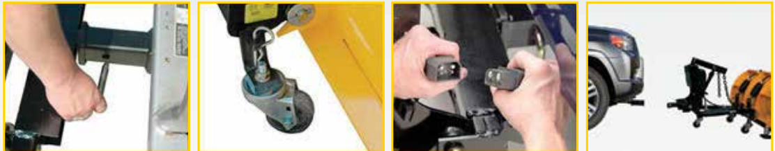
1: Stecknagel einhängen oder entfernen 2: Räder positionieren 3: Stromversorgung anschliessen, abhängen 4: Schneepflug wegrollen
